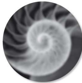
Brennfleck eines herkömmlichen Generators: 0,7 mm
